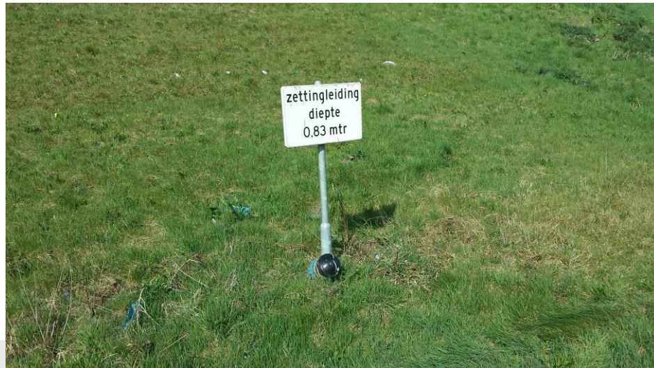
Foto: Duidelijk markering zettingsleiding.
